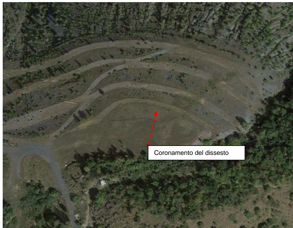
Figura 16 Ubicazione su foto aerea del sito d'intervento con indicazione della linea di frattura evidenziatasi nell'ambito dei depositi detritici
