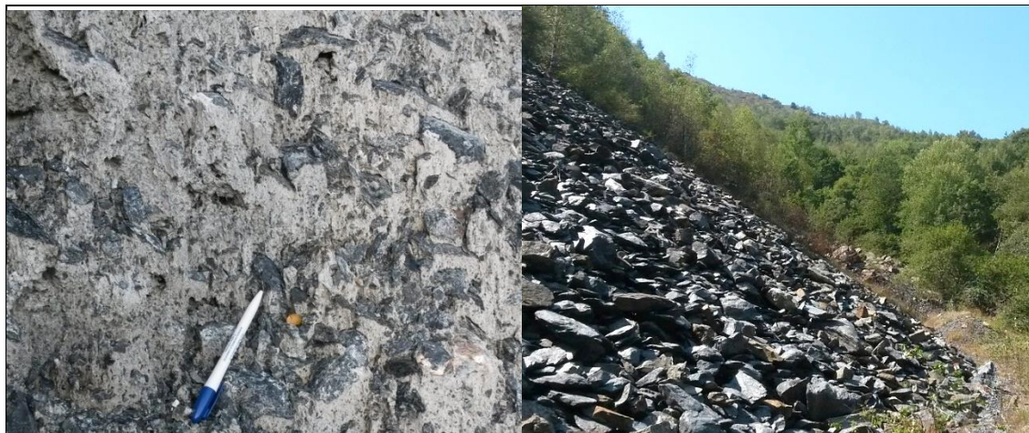
Figura 3: Affioramenti depositi antropici (“matrix supported”, sx.; “clast supported”, dx.)
