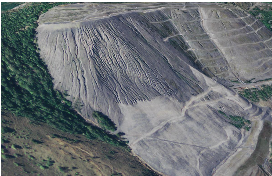
Figura 6: Vista prospettica dell'accumulo di discarica sul lato Est del versante, con evidenza dei solchi erosivi
